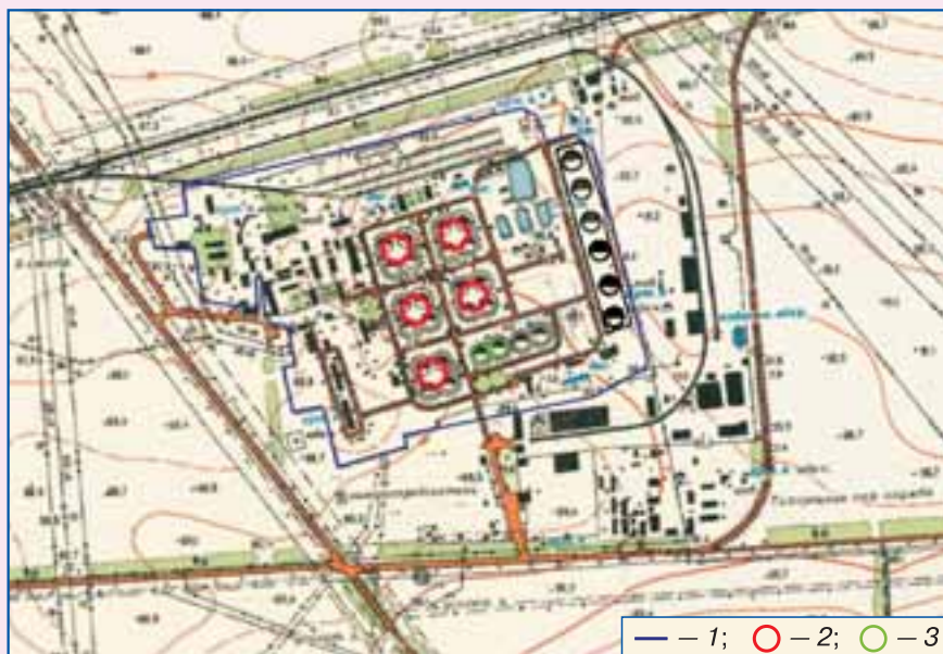
Рис. 1. План реконструкции перевалочной нефтебазы: 1 — граница нефтебазы; 2, 3 — проектируемые соответственно РВСпк-50000, РВСп-10000
