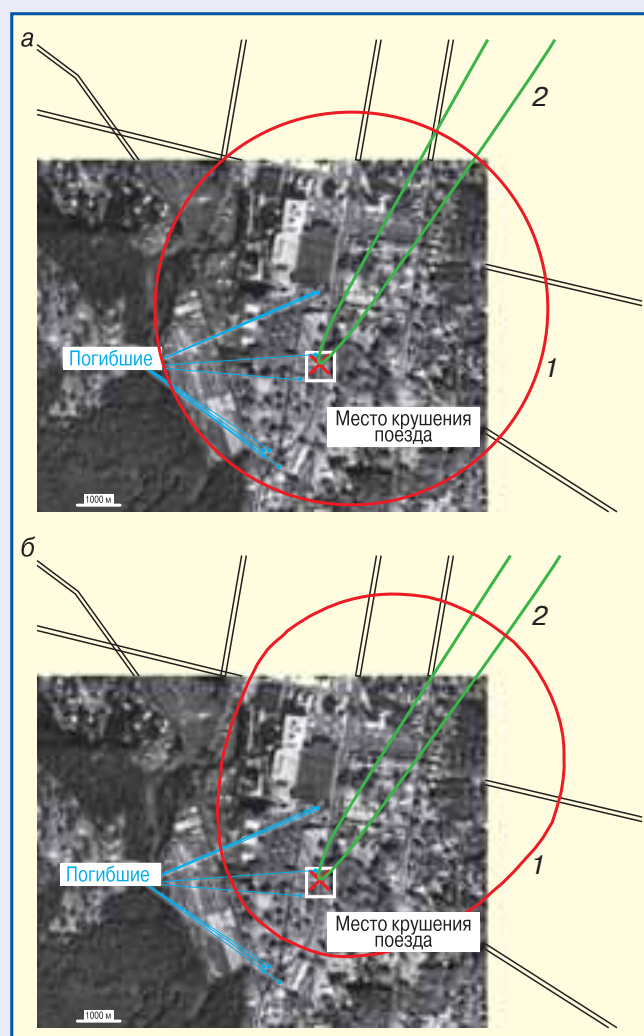
Рис. 5. Схема расположения погибших при аварии в Грэнитвилле (США, 06.01.05) и расчетные зоны смертельного поражения при разной скорости ветра:
