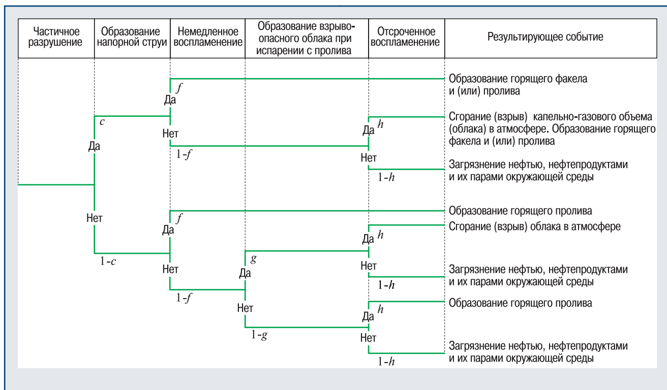
▲ Рис. 1. Дерево событий при разгерметизации подземного участка МТ с нефтью, нефтепродуктом
